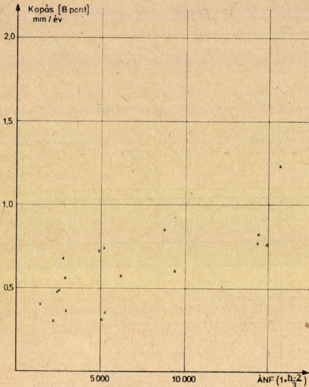
9. ábra. A belső keréknyomban mért burkolatkopás és az ANF paraméterének összefüggése
