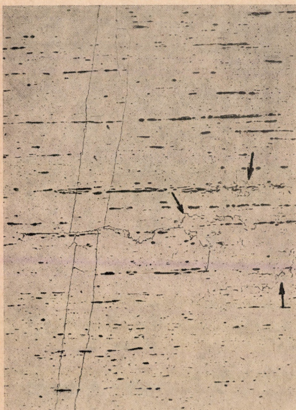
3. ábra. Egymástól kb. 1 mm távolságban egyszerre fejlődő két, vese alakú felnyílás képe a vízszintes síkban és a nyílal jelölt hosszirányú repedések. Marataltan csiszolat, nagyítás 12,5 \times -es
