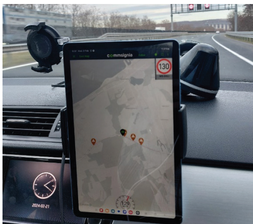
3. ábra: Járművön belüli jelzés az M7-en Kőrös-hegy térségében (In-vehicle signage – IVS) (forrás: saját felvétel)
