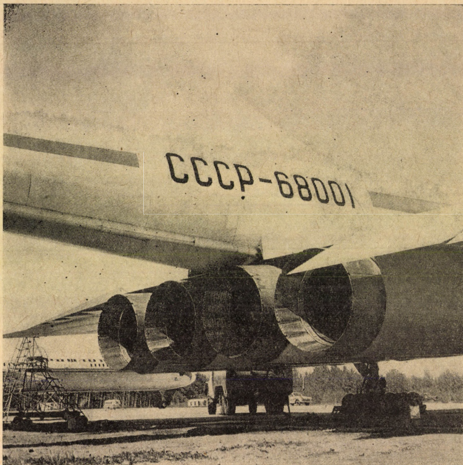
4. ábra. A TU-144 típusú repülőgép nagy teljesítményű hajtóművei 2500 km/h sebességű repülést tesznek lehetővé
