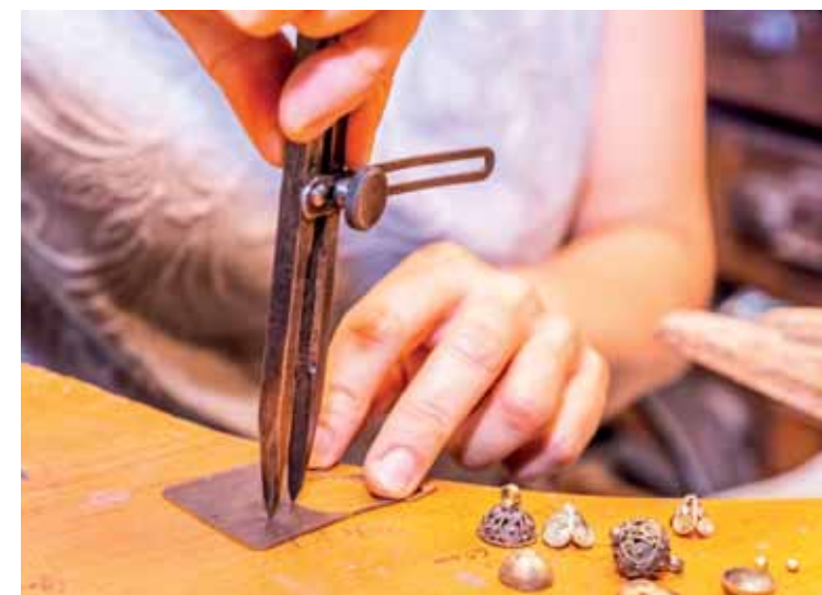
A pitykés körzővel szerkeszti ki leendő gombjának alapját – Ezúttal rézlemezről
