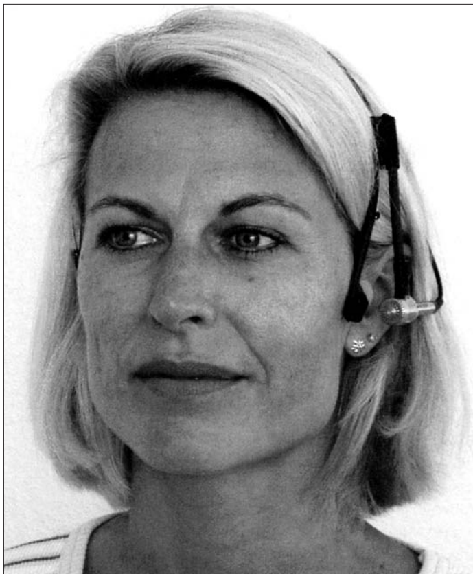
Zajmérés mikrofonnal a fejhallgató kengyelen
