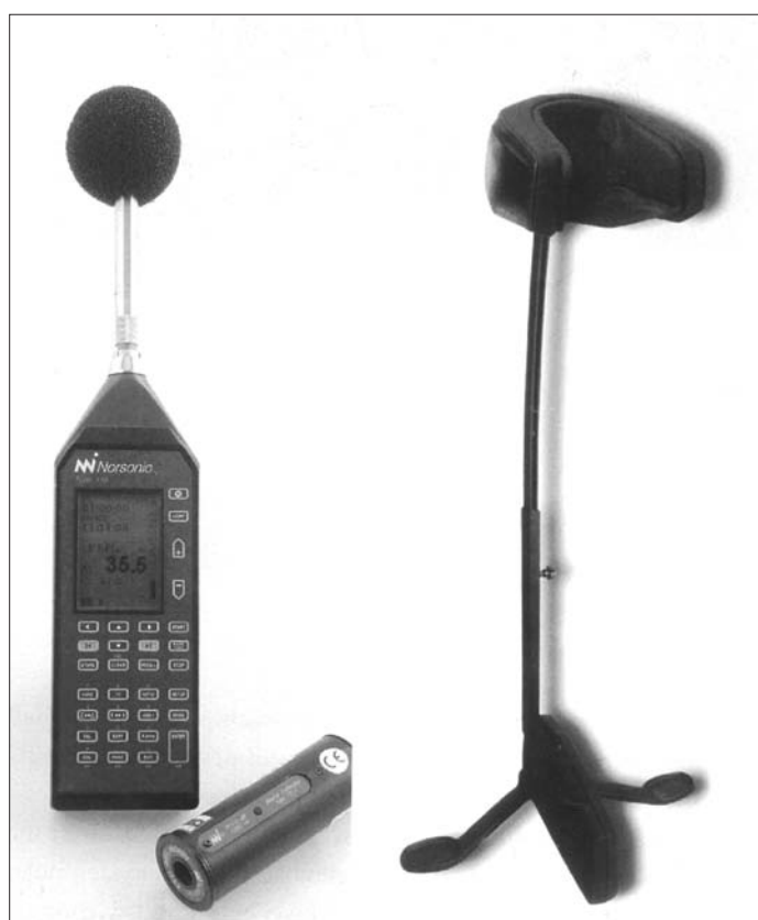
Precíziós zajszintmérő eszköz Norsonic 118 – Zajvédő „Hearwig” fejtámasz
