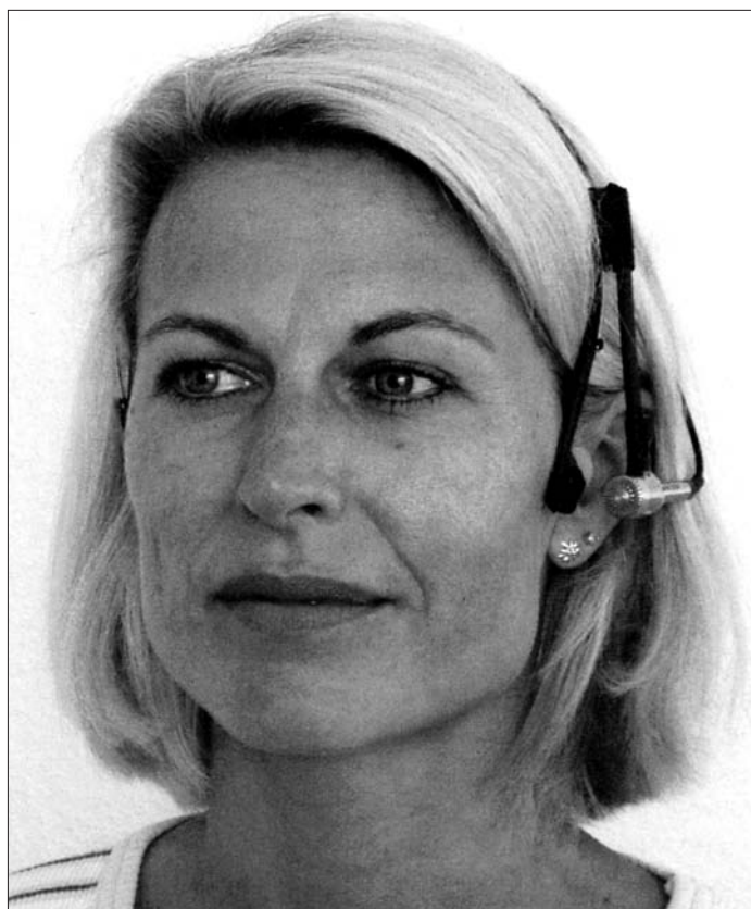
Zajmérés mikrofonnal a fejhallgató kengyelen
