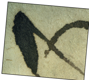
5. A tinta mikroszkópos képe papíron, 200-szoros nagyításban
