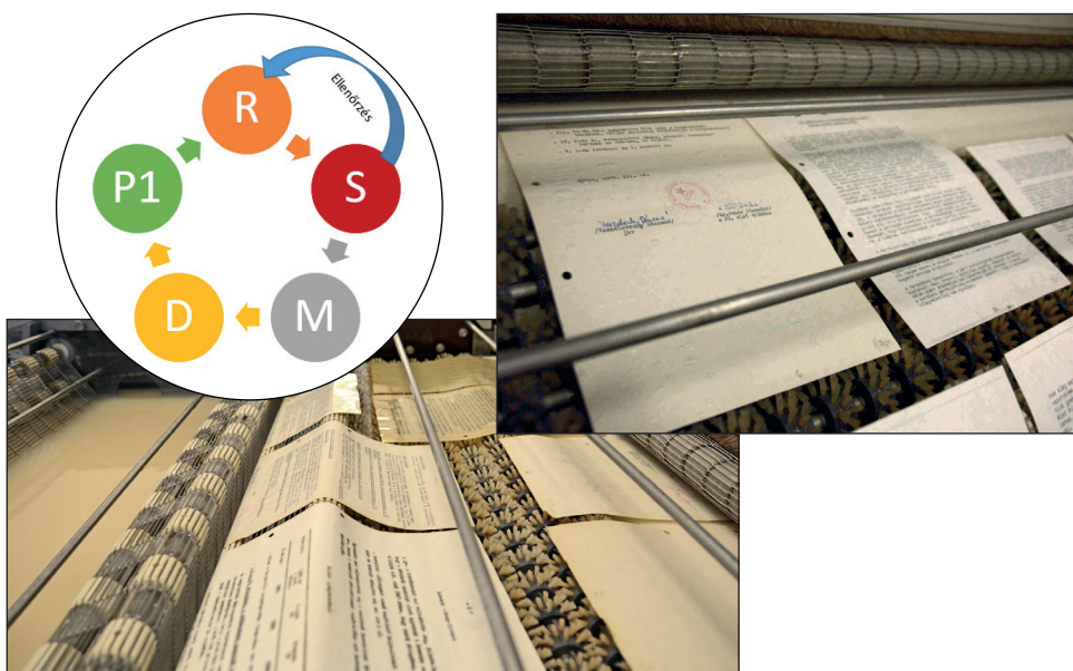
A Bückeburgi eljárás folyamatábrája, és a Neschen C900 készülék
