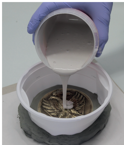
8. A plasztilinbe ágyazott fedél leöntése szilikonnal
