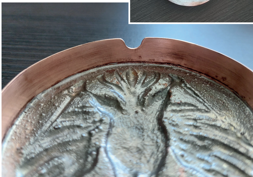
17. Az ónnal kiforrasztott galvanomósolat hátoldala
