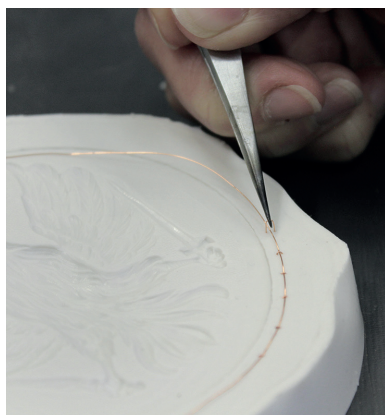
10. „U” alakú tűkkel a vékony rézdrót rögzítése a minta köré.
