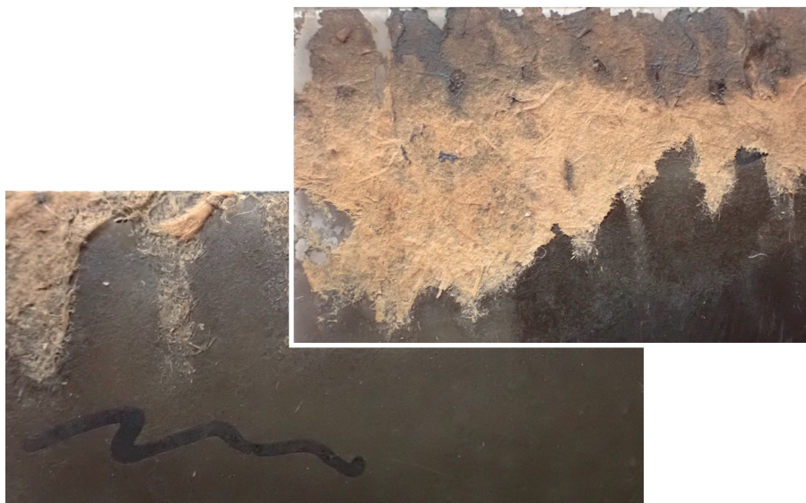
24–25. Zselatinos emulzióba tapadt papírmaradványok tisztítás előtt (fent) és után (lent)
