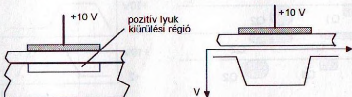
2. ábra. A pozitív lyuk kiürülési régió elhelyezkedése a félvezető alaprétegben és a feszültség „ eloszlása ” az elektróda alatt
