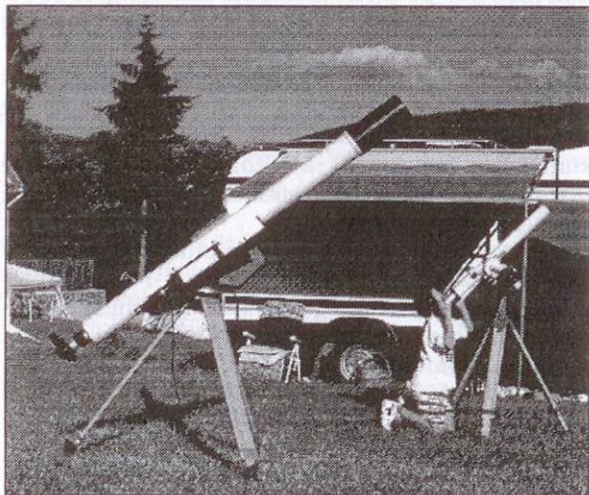
Csukovics Tibor 110/1650-es, Zeiss-objektívvel szerelt refraktora
