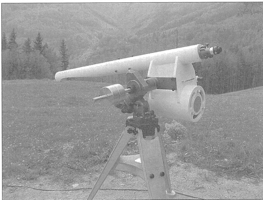
A cikkben említett ferdetűkrős rendszer (Kutter-távcső)
