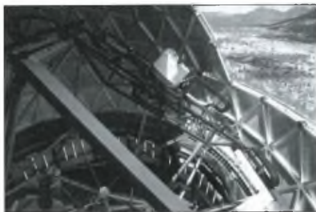
A HET „óragépe” a távcső forgatásából és a primer fókuszba szerelt mozgatómechanizmusból tevődik össze. Balra lent láthatók a felvétel idején még félig kész tükkör szegmensei
