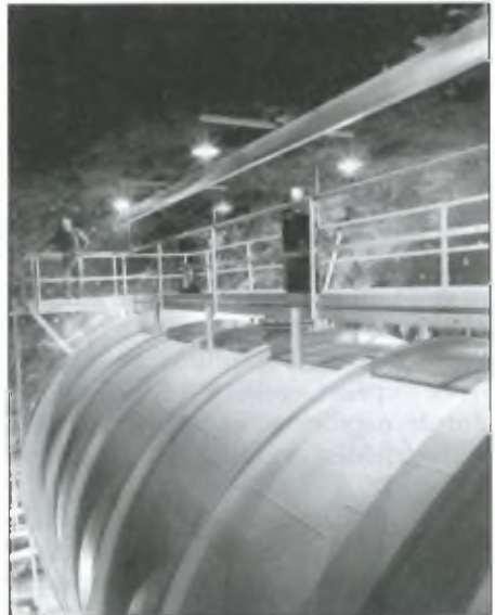
Raymond Davis földalatti neutrínó-detektorában 615 tonna perklór-etilén található. Havonta néhány alkalommal egy-egy neutrínó kölcsönhat egy klór atommaggal, amely átalakul argonná
