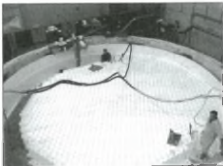
Készítik a GMT első tükrének öntőformáját
