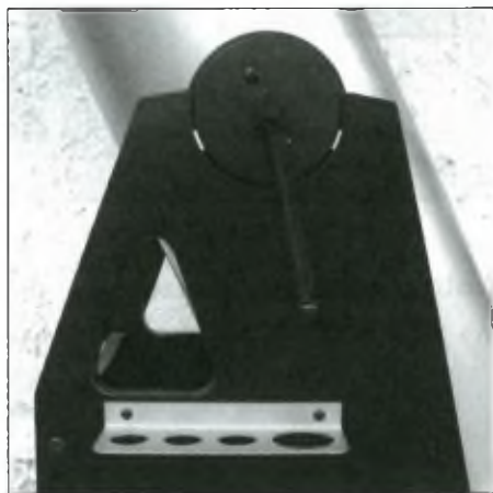
A feszítőrugó és „környéke”. Jól látható a függőleges csapágyazás két teflonpárnája és a villára szerelt praktikus okulártartó
