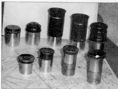
A hátsó sorban: 6,7 mm-es Meade Plössl, 6 mm-es japán orthó, 6 mm-es Synta GL, 9 mm-es Synta GL, 17 mm-es katonai Erfle. Az első sorban: 24,5 mm-es okulárok: 5 mm-es Vixen orthó, 17 mm-es orthó (mikroszkópos okulár), 6 mm-es Vixen orthó, 10 mm-es cseh Erfle (ATC)
