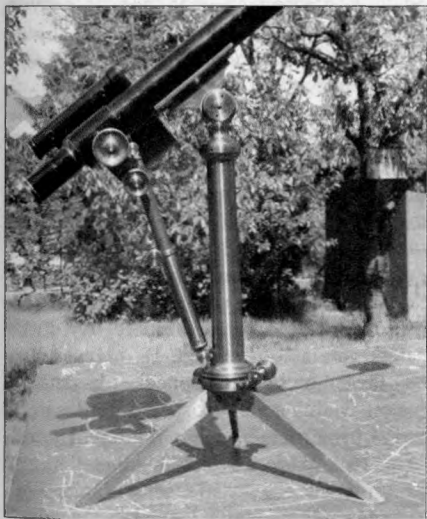
A tubus függőleges rögzítését és finommozgatását a távcső és az állványoszlop közötti rudazat teszi lehetővé. Közvetlenül a lábak fölött látható a vízszintes finommozgatás csavarja
