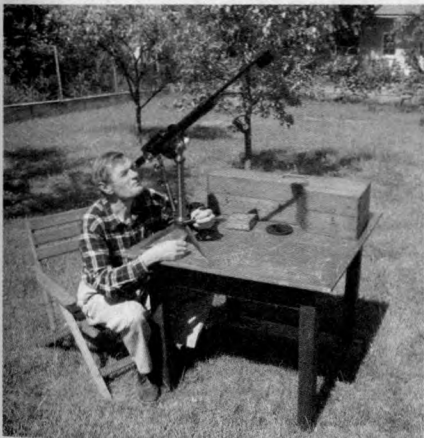
Az azimutális kialakítású asztali állvánnyal viszonylag kis horizont feletti magasságban kényelmes csak az észlelés. A nappali vizsgálódáshoz eredeti teresztrikus okulárt is rejt a műszer ládája
