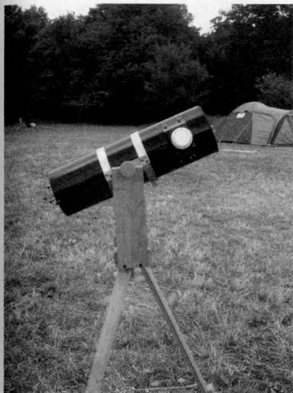
Szerzőnk saját készítésű, ultrakönnyű, hiperhordozható 100/400-as Newton-reflektora az ágasvári észlelőréten, a 2006-os ifjúsági táboron
