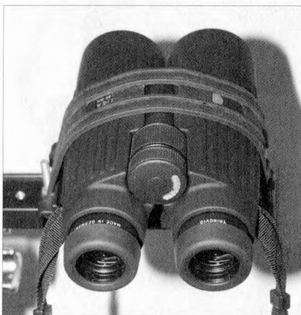
A Leica állványra „béklyózva”. Jól látható a furtangos élességállító gomb
