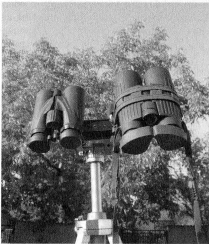
Két binokulár egy állványon: a William Optics 10x42-ese és a Leica 10x50-es Trinovid
