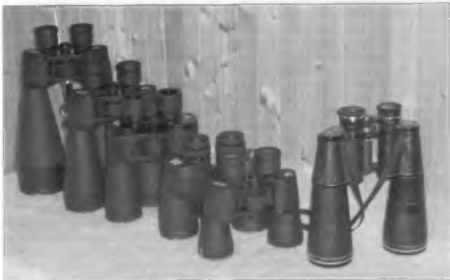
Binokulár-sorozat: Bairól obbra 20x80, 15x70, 8x56, 10x50 Marine, 10x50 LF, végül 20x60-as Tenta
