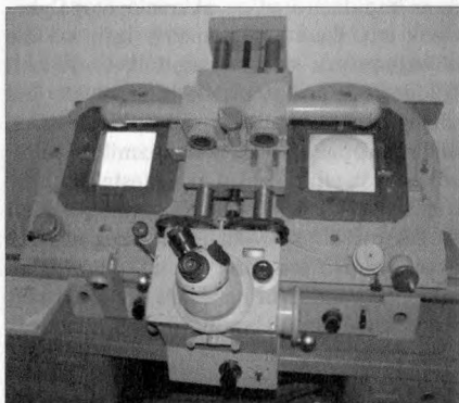
Az MTA KTM CSKI Zeiss sztereokomparátora, amellyel egybeként a Schmidt-lemezeket mérik ki
