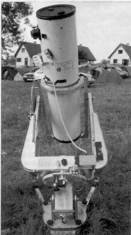
A parallaktikus villás szerelésű Newton-reflektor a tarján észlelőréten. Jól látható a tengelye körül elforgatható tubus
