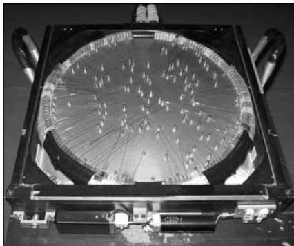
Az 1,22 m-es UK Schmidt hat fokalátómezőben kb. 100 spektrumot rögzítő műszerének fókuszeleme. Az egyedi objektumok fényét optikai szálak vezetik el a kb. 15 m-re található spektrográfhoz
