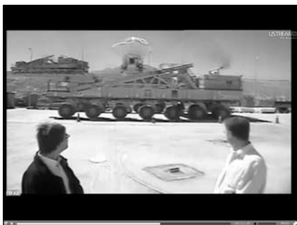
A műsor kedvéért beindították az ALMA óriási járművét, mely az egyenként 100 tonnás rádiótávcső-egységeket szállítja az obszervatórium területén
