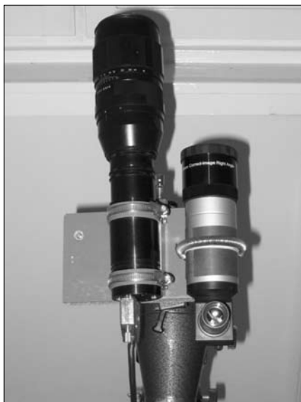
Szerzőnk műszeregyüttese (200 mm-es teleobjektív és StarLight MX516 CCD)
