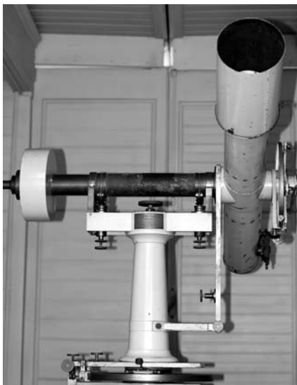
A Rio de Janeiro-i obszervatórium Gustav Heyde műhelyében készült 110/900 mm-es passzázs-refraktora
