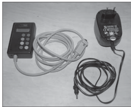
Kézvezérlővel történik a precíz élesreállítás
