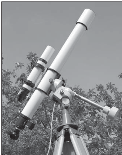
80/1200-as Zeiss AS objektívvel szerelt naptávcsövem
