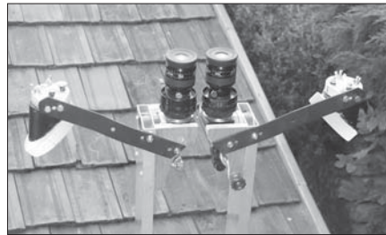
A segédtükrőtartó barkácsboltban vásárolt vasalattól készült
