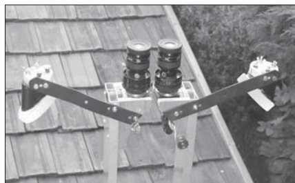
A segédtükörtartó barkácsboltban vásárolt vasalattól készült
