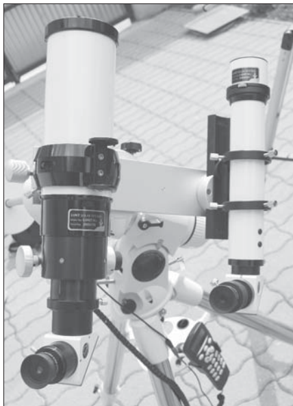
A két Lunt modell. Jól megfigyelhető a szűrő-finomhangolás, illetve a fókuszálásra alkalmazott különböző megoldások
