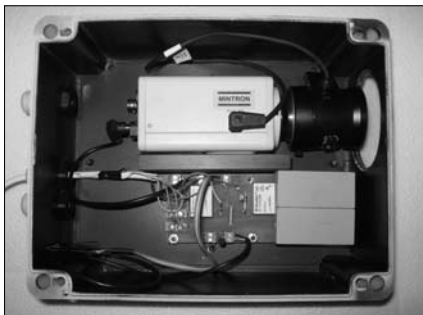
A zárt, vízálló kameraház alapfeltétele az állandó felállítású kameráknak
