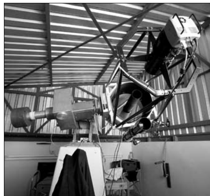
Az IAS 50 cm-es Keller-féle Cassegrain távcsőve, mellyel a nemzetközi egyesület tagjai igen szép képeket készítenek
