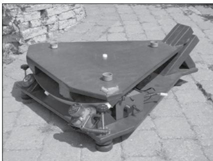
Alt-azimutból ekvatoriális! A platform óratengelye a jobb szélén látható, a két lapot összekötő rövid csomak. A mechanika órágeppel ellátott
