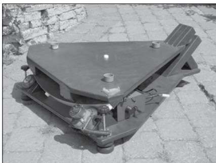
Alt-azimutból ekvatoriális! A platform óratengelye a jobb szélén látható, a két lapot összekötő rövid csonk. A mechanika órággel ellátott
