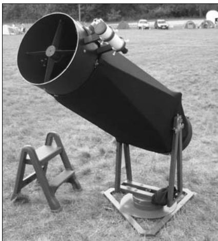
Házi készítésű, rácsos tubusú Dobson-távcső: Pete László 35 cm-es műszere. A rácsos szerkezeten a környező fények kiszűrésére szolgáló takaró feszül
