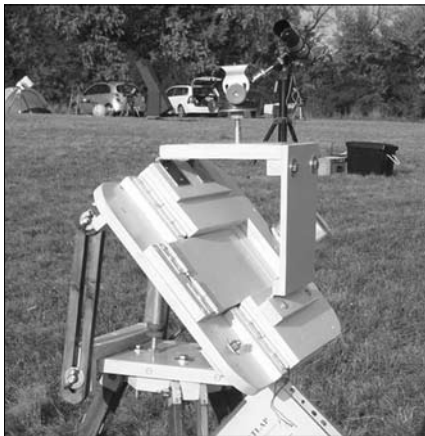
Újvárosy Antal továbbfejlesztett pajtaajtó-mechanikája. A rektaszenciós tengely a két lapot összefogó zsanérsor, amelynek pontos pólusraállását pólustávcső könnyíti meg. A mechanika órágéppel is ellátott!
