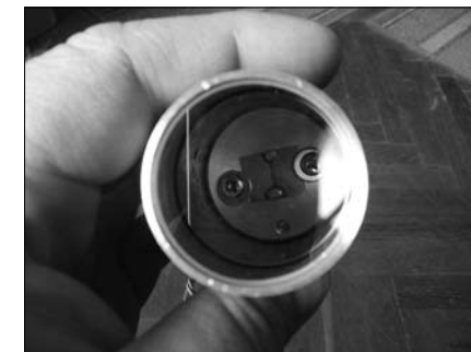
A kezemben tartott tesztelőben az ismertett eljárással készült rést látjuk a kompenzátor lencsén keresztül. A két csavar a rést rögzíti az alaplamezre, melyen a 0,7 mm-es furat van. A lencse foglalata alumínium, mely szorosan van beillesztve a PVC csőbe
