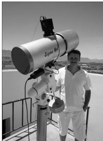
Gennagyij Boriszov saját készítésű, 20 cm-es, f/1,5-ös asztrográfiájával, amely négy hónap alatt két üstökösöt eredményezett készítőjének, de egy ilyen műszerrel fedezte fel Vitalij Nyevszkij a C/2013 V3 jelű kométát is
