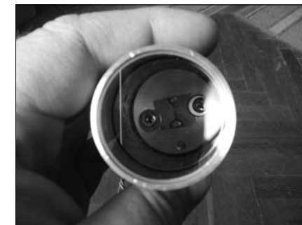
A kezemben tartott tesztelőben az ismertetett eljárással készült rést látjuk a kompenzátor lencsén keresztül. A két csavar a rést rögzíti az alaplemeze, melyen a 0,7 mm-es furat van. A lencse foglalata alumínium, mely szorosan van beillesztve a PVC csőbe
