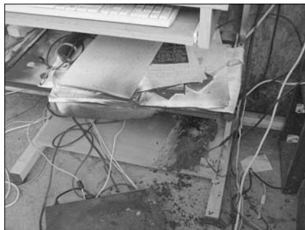
A megégett polc – itt voltak a gépek és az elosztó
