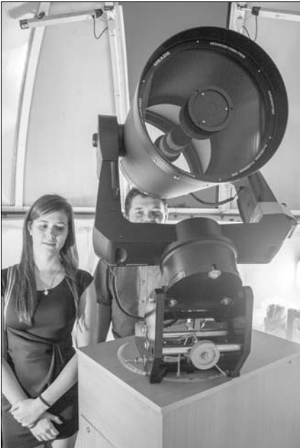
A súlysápi csillagvizsgáló főműszere, a 35 cm-es Schmidt-Cassegrain-távcső
