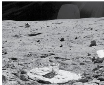
Az Apollo-16 űrhajósai által kihelyezett Passive Seismic Experiment műszere a kép előterében (Lunar and Planetary Institute)
