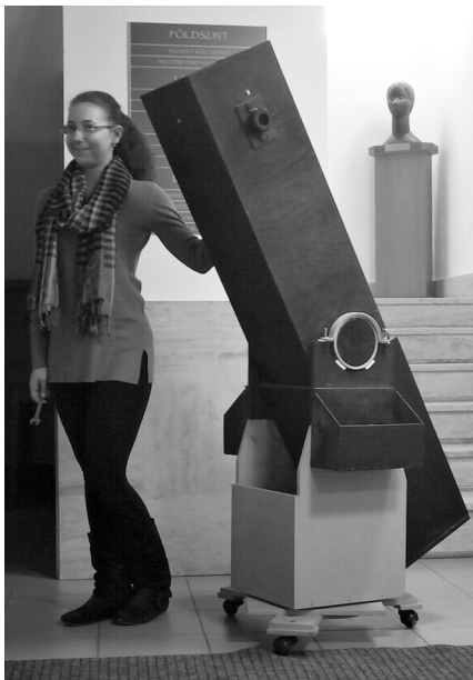
Kalup Csilla a Lehel Vezér Gimnázium szögletes tubusú Dobson-távcsővével, melyben az 1962-es gyártású főtükör rejtőzik
