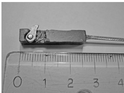
A szerkezet egyik legkisebb része alig 2,5 cm-es egység, ehhez csatlakozik a bowden. Maga a kilincsyelv kb. 6 mm-es
