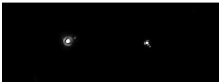
A \delta Cygni. Balra 152/1800 Dall-Kirkham 5200 mm eredő fókuszzal, jobbra 150/1240 Newton háromszorozóval. Jól látszik az évek alatt kissé deformált felület miatt három ponton megszakadó első diffrakciós gyűrű. A kísérő helyzete eltér a két képen, nem fektettünk rá nagy hangsúlyt, ugyanis most a bontás ténye fontosabb volt. Kamera: ALCCD QHY 5L-II
