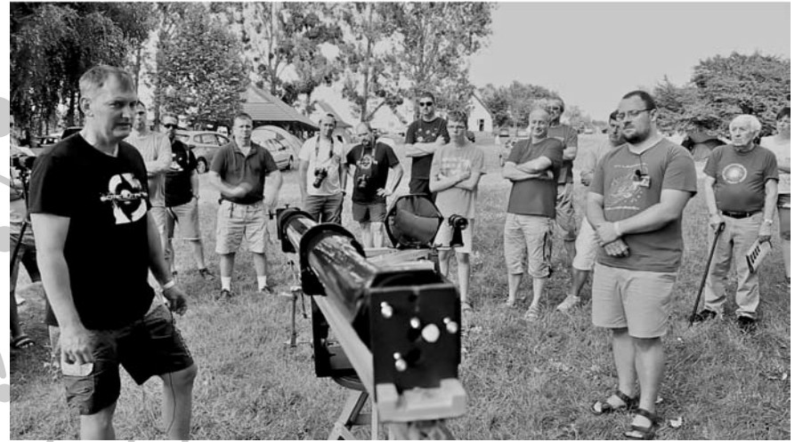
Schlosser Sándor saját építésű 15 cm-es Kutter- távcsöve. Ezen a tubuson sincs bonyolultabb szerzőmeggéppel készült alkatrészt, az építője egyéni ötletekkel pótolta azokat, illetve fellelt alkatrészeket használt fel célszerű átalakítás után (csillagnezok.hu)
