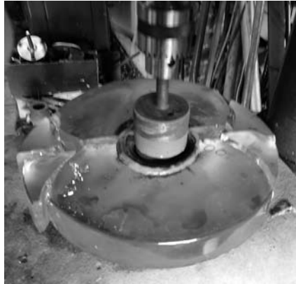
Aki alkotómunkára adja a fejét, nem ússza meg kudarcok nélkül. A képen egy 250-es Cassegrain-főtükör látható, amely a kifúrási folyamat során „felrobbant” az első ránézésre nem jelentősen tűnő belső feszültség miatt. Az üveg a szerző fúrógépének asztalán látható, a szomorú eseményt Berente Béla örökölte meg
