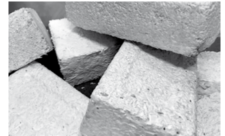
Gomba segítségével, a micélium, mezőgazdasági hulladék és fadarabok felhasználásával előállított téglák (2018 Stanford-Brown-RISD iGEM)
