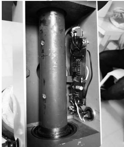
A tápfeszültséget szolgáltató nyomtatott áramkört lap a helyére építve
