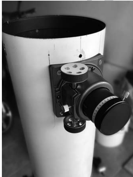
A fókuszírozó egy egyszerű Crayford-kihuzat
