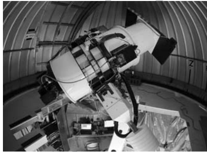
Az ATLAS program által használt Wright-Schmidt rendszerű távcső építésénél több szokatlan megoldást is alkalmaztak, többek között a fényzár nem a CCD kamera előtt, hanem a távcsőtubus előtt kapott helyet, redőnyös kivitelben
