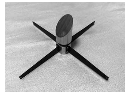
A segédtükörtartó, még festés előtt. A póklábak egy 200/800-as távcsőből származnak
