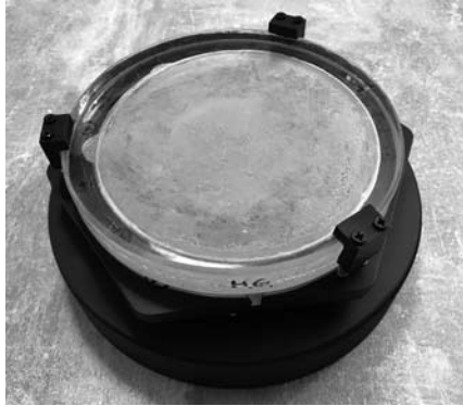
A félkész, gőzölés nélküli tükör a foglalatba próbálva
