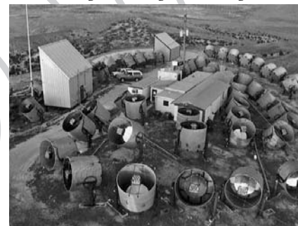
A nagyenergiájú kozmikus részecskék által a földi légkörben keltett kaskád-részecskék detektálására épített Fly's Eye (Légyszem) műszeregyüttes, amellyel az „Uramisten!” részecskét is elcsípték (alchetron.com – Free Social Encyclopedia for the World)
