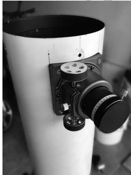
A fókuszírozó egy egyszerű Crayford-kihuzat
