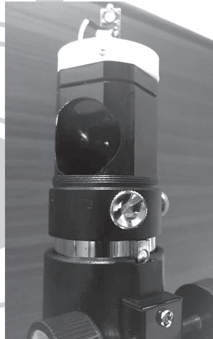
A jusztírózó működés közben. Lehet látni a visszaverő lézerfényen, hogy állítani kell még a főtükrrön
